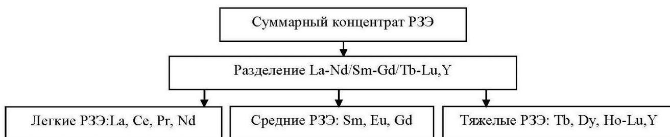
Рисунок 2.16 – Схема 2 разделения группового бастнезитового концентрата РЗЭ, реализованная на предприятиях в Китае
